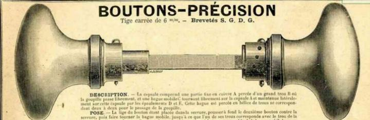
**DESCRIPTION** — La capsule comprend une partie fixe en cuivre à percée d'un grand trou il est le gouppille passe librement, et une bague mobile tournant librement sur la capsule à et maintenue latéralement sur cette capsule par les épaulements D et E. Cette bague est percée en hélice de trous se correspondant dans la hélice, pour servir à la gouppille.
