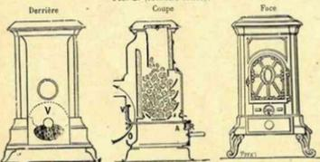
Dans les appareils à feu continu ordinairement usités, on modère la combustion en arrêtant plus ou moins le tirage au moyen de clé, diaphragme, etc., d'où danger de renversement du courant gazeux, c'est-à-dire de refroidement.
